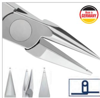
Pinza a becco d'uccello per piegare e formare anse. La punta conica lunga è adatta per formare anse precise su fili sottili. La scanalatura consente la localizzazione e la duplicazione di loop.
